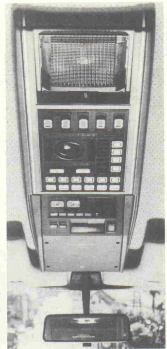
Fast schon im (Auto-) Himmel: Das 'Cockpit' System RM-710 von Panasonic besteht aus digitalem Empfangsteil, Equalizer, 4fach-Balancesteller und Kassettendeck. Gesamtleistung der beiden Verstärker: 120 W.
