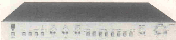
HiFi-Stereo-Vorverstärker SPR 80 von Kraus. Phono-Eingänge: MC 1 x 10 mV, 47 kOhm; MM 1 x 2,5 mV/47 kOhm. Klirrfaktor: 0,007 %. Frequenzgang (Reserve): 7 Hz — 80 kHz. Fremdspannungsabstand: 110 dB.
